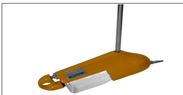
Figura 5 – USDH-48 para ser usado com haste em medição a vau. Fonte: imagens cedidas pela empresa operadora da rede hidrométrica (2013).
