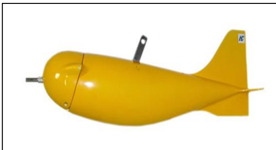
Figura 4 - USD-49 para ser usado com guincho. Fonte: imagens cedidas pela empresa operadora da rede hidrométrica (2013).
